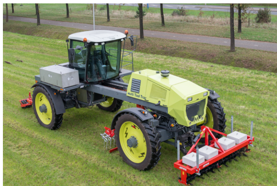
Abb. 23: Prototyp eines dieselektrischen Traktors (© Multi Tool Trac BV)
