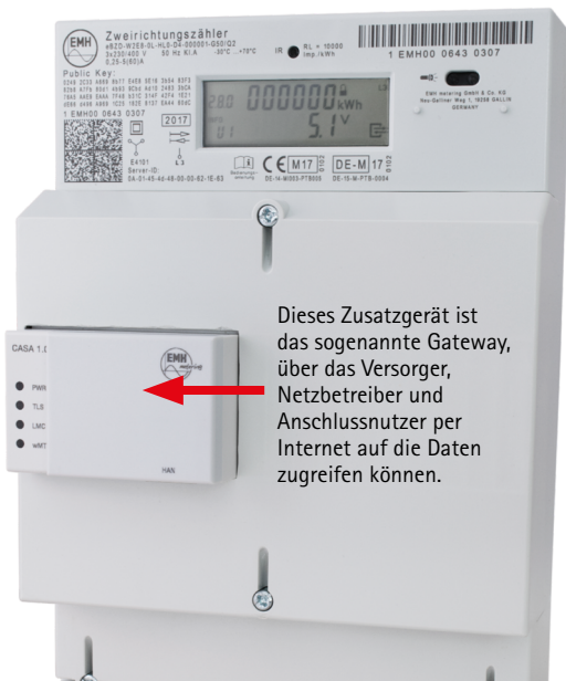
Abb. 5: Intelligentes Messsystem mit Smart-Meter-Gateway (© EMH metering GmbH & Co. KG)
