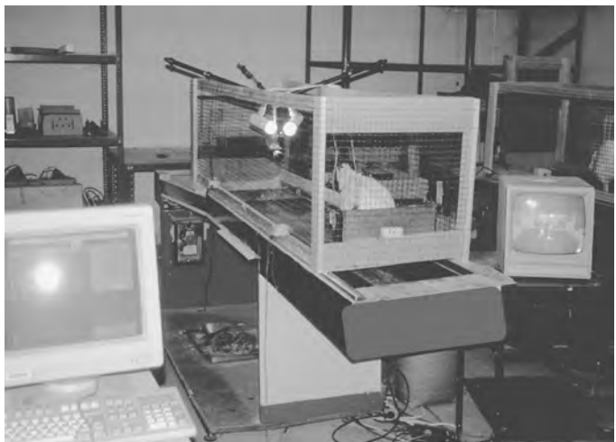
Abb. 2: Versuchsaufbau zur Erfassung des Bewegungsmusters mit einem Videotracking-System Experimental design for registration of locomotor pattern with videotracking system
