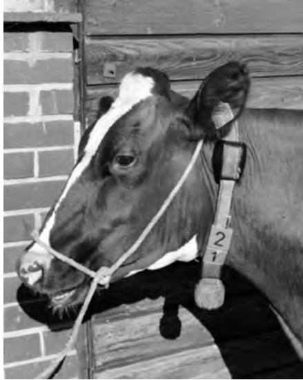
Abb. 1: Kuh mit Respaktor zur Messung von Wiederkauzeit und Aktivitätsverhalten Fig. 1: Cow with respiration collar for measurement of rumination time and activity behaviour
