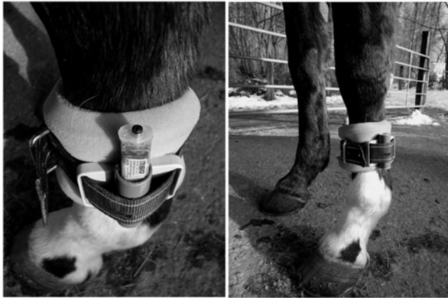
Abb. 2: Befestigung des MSR145 Datenlogger am Röhrrbein des linken Vorderbeins über dem Fesselgelenk
