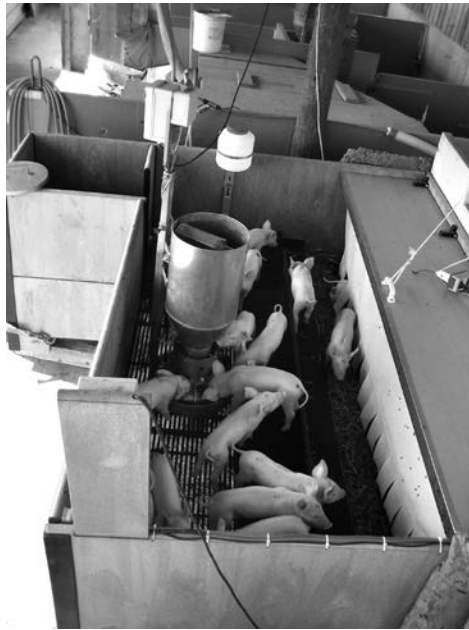
Abb. 1: Die für die Untersuchung verwendete technische Ferkelamme „Nursery“ mit beheizter Ferkelkiste (rechts), Aktivitätsbereich mit prozessorgesteuertem Futterautomat (in der Mitte) und Kotecke (oben links) (Foto: Rzezniczek)
