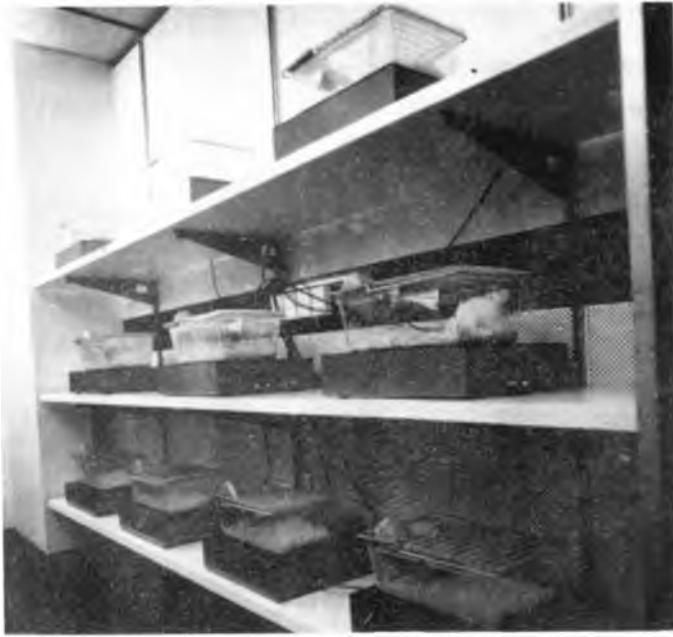
Abb. 2: Motilitätsmessungen bei Ratten (Stoelting-Baukastensystem mit 10 Sensoren). Der Raum ist abgeschirmt (Faraday'scher Käfig)
