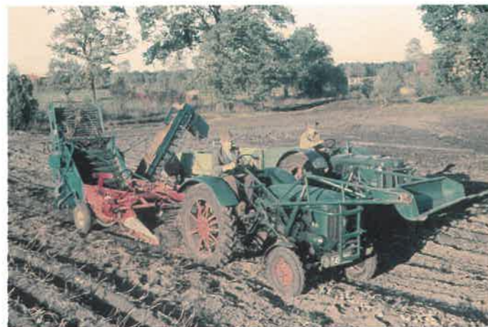
Erste Versuche zur geteilten Ernte mit zweireihigem Rodelader auf der Basis eines Vorratsroders
