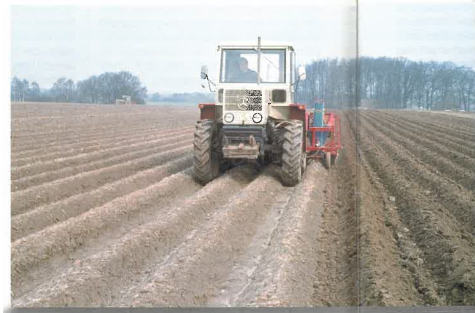
Zweireihige Legemaschine, vor allem für vorgekeimte Kartoffeln, mit drei Becherbändern pro Legeeinheit
