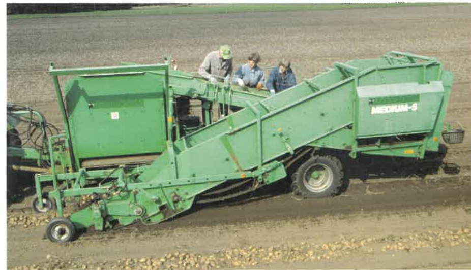
Einreihiger Sammelroder mit seitlicher Dammaufnahme in einstöckiger Bauweise
