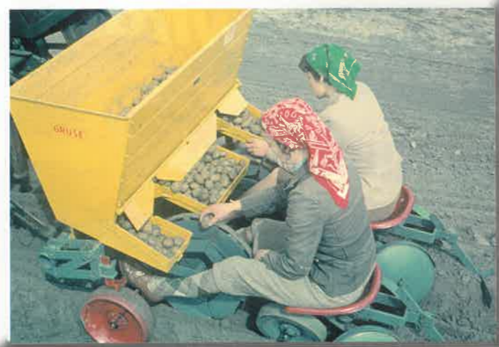
Kartoffellegemaschine mit Handeinlage
