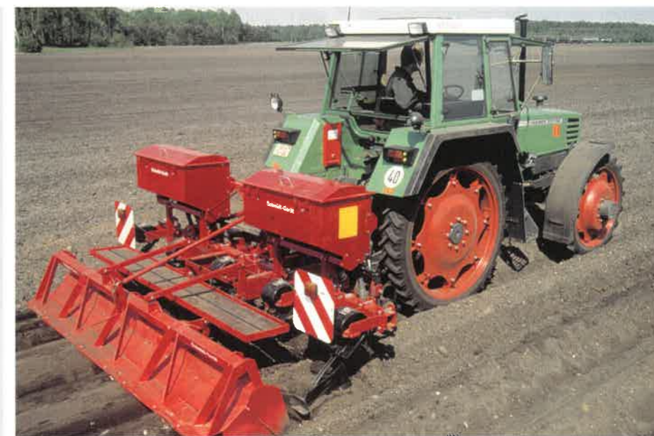
Pflegegerät mit aufgebautem Reihendüngerstreuer
