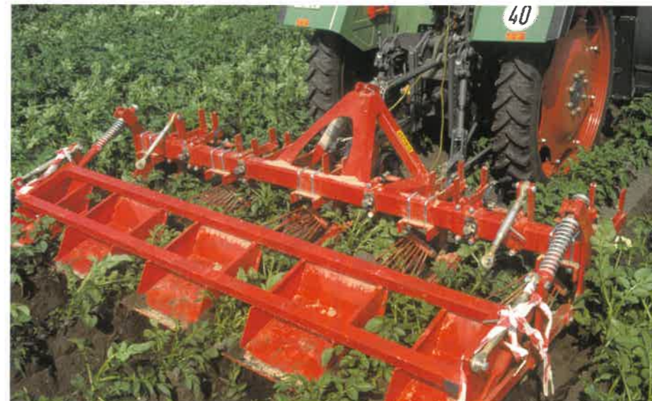
Aufbau des Enddamms kurz vor Bestandesschluss
