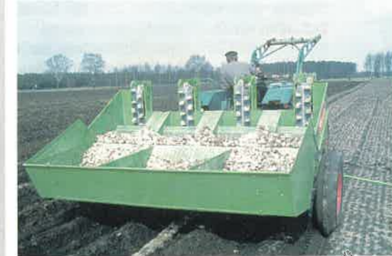
Vierreihige Legemaschine mit durchgehendem Kippbunker
