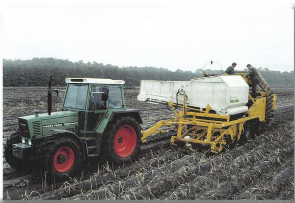
Zweireihiger Bunkerroder mit seitlicher Dammaufnahme
