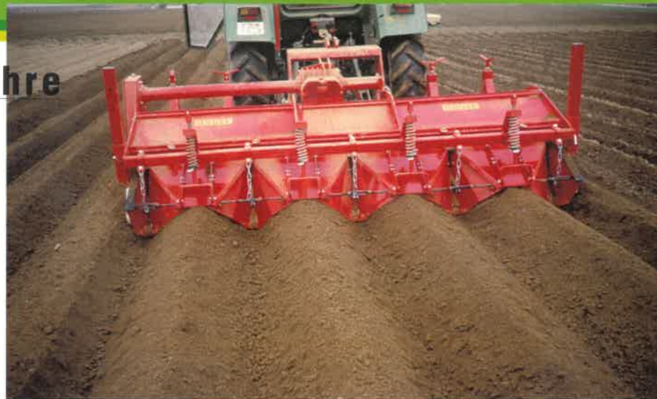
Reihenfräse zum Aufbau der Kartoffeldämme auf schwereren Böden
