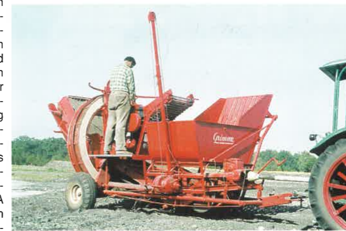
Einreihiger Siebketten-Sammelroder in zweistöckiger Bauweise mit querliegendem Hubrad
