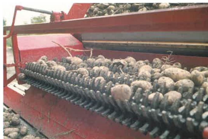
Schonende Erd- und Klutentrennung durch einen Gummisternwalzen-Enterder
