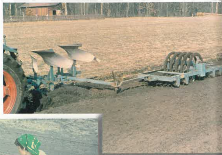
Grundbodenbearbeitung mit Anbau-Volldrehpflug und Packer
