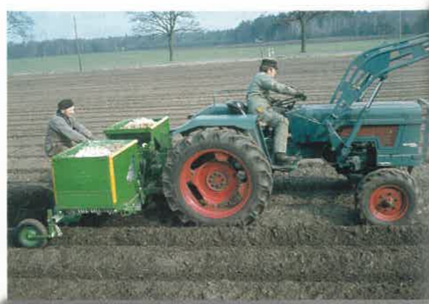
Entsteinen der Kartoffelflächen mit zweireihigem Siebkettensammler
