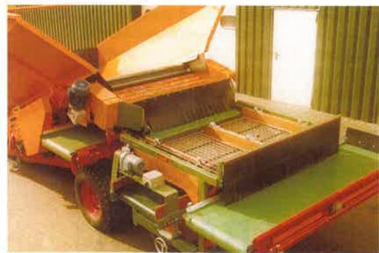
Vorsortieren der Kartoffeln bei der Einlagerung mit einem Flachsiebvorsortierer
