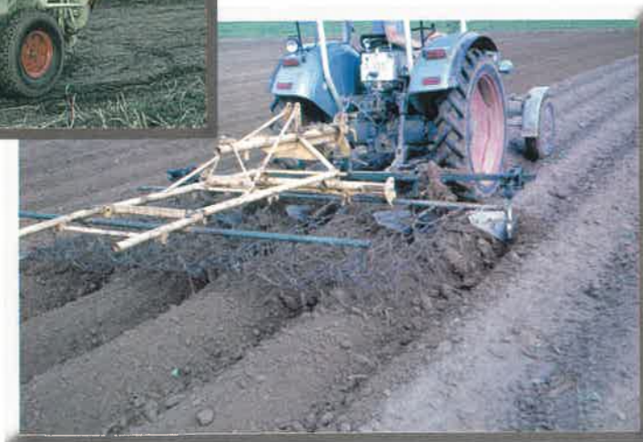
Häufel-Netzegen-Kombination zur mechanischen Unkrautbekämpfung
