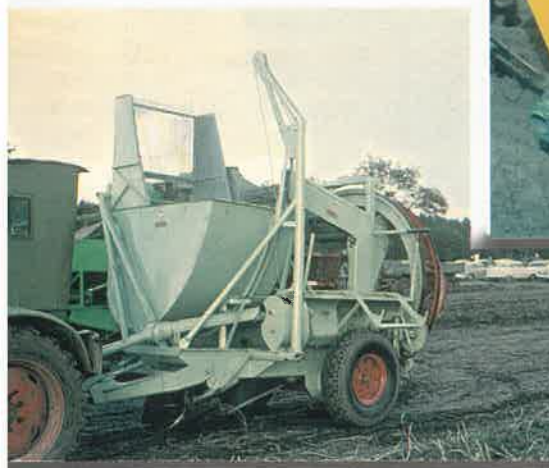
Einreihiger Sammelroder mit Schwingsieb und mechanischem Kippbunker
