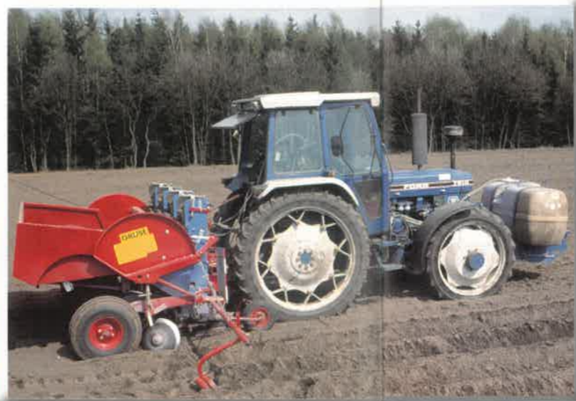
Vierreihige Kippbunkerlegemaschine mit vier Laufrädern und Flüssigbeizeinrichtung
