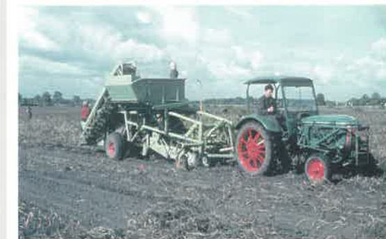
Einreihiger Schwingsiebroder mit hydraulischem Kippbunker
