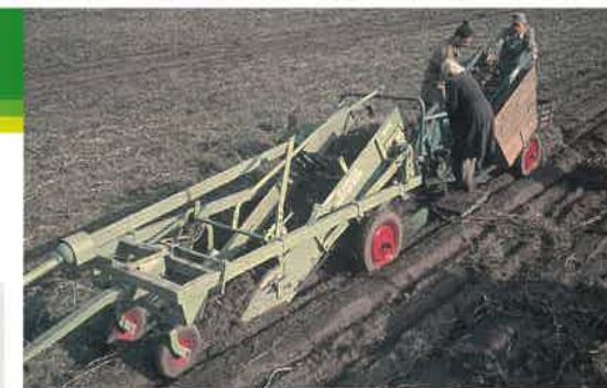
Siebketten-Vorratsroder mit angehängtem Verlese- und Absackstand
