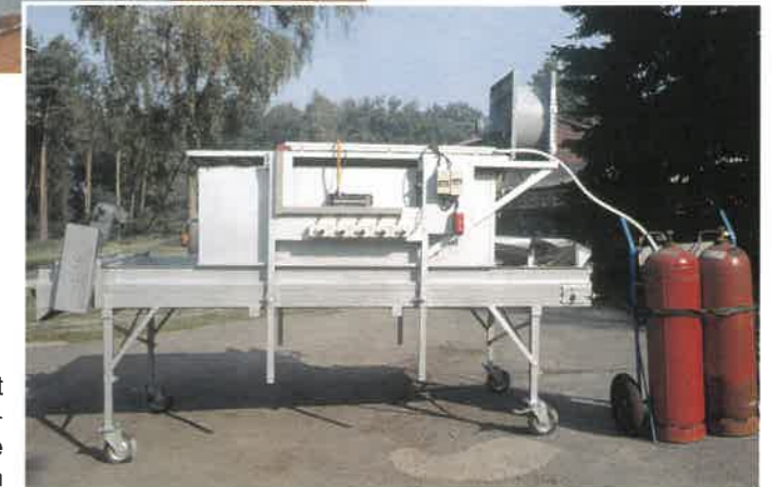
Geringere Beschädigungsempfindlichkeit der Kartoffeln durch eine Schnellerwärmung über Infrarotstrahlung bei der Auslagerung
