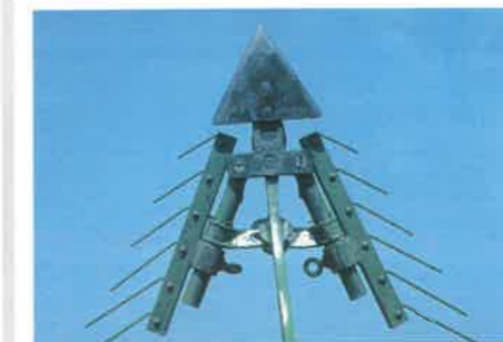
Der Häufelstriegel – Häufeln und Striegeln mit einem Werkzeug
