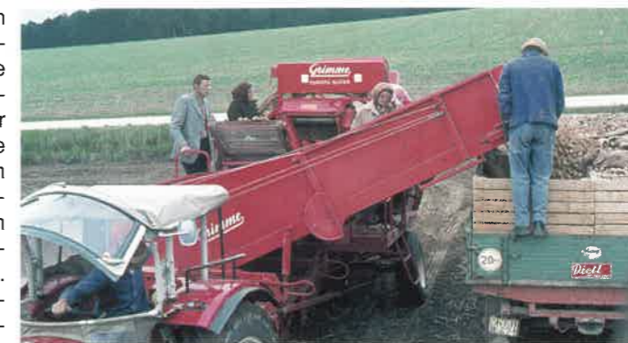
Der Rollbodenbunker erleichterte das Befüllen von Großkisten auf dem Feld
