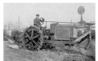
Motorpflüge – hier ein Modell mit 40-PS-Motor auf der „Grünen Woche“ 1928 in Berlin – sind für lange Zeit Spezialmaschinen für Großbetriebe (© Messe Berlin GmbH)
