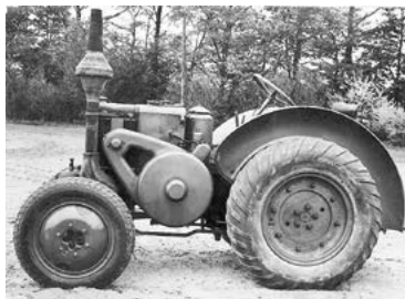
Gummireifen vervielfachen die Einsatzstunden des Schleppers – fortan sind auch leichte Bestell- und Pflegearbeiten sowie Ernte- und Transportarbeiten möglich (© ATB-Collection | https://mediatum.ub.tum.de/1544761 )
