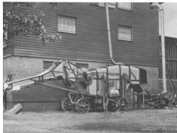
Auch der Esso-Hof wird als Häckselhof konzipiert; der Dreschsatz kann von einer Person bedient werden, Korn und Strohhäcksel werden getrennt in Bergerräume geblasen (Esso 1955)
