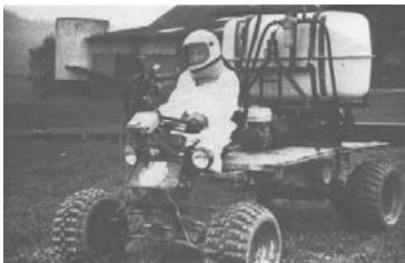
Leichtfahrzeug mit aufgebautem Pflanzenschutzgerät (© Wennekamp | KTBL 1988a)
