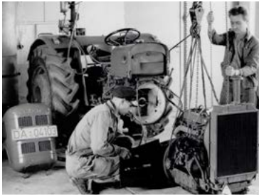
Für die Messungen werden die Motoren ausgebaut, um sie dann auf einem Motorenmesstand prüfen zu können (© KTBL/DLG; Bearbeitung: F. Uhlig)
