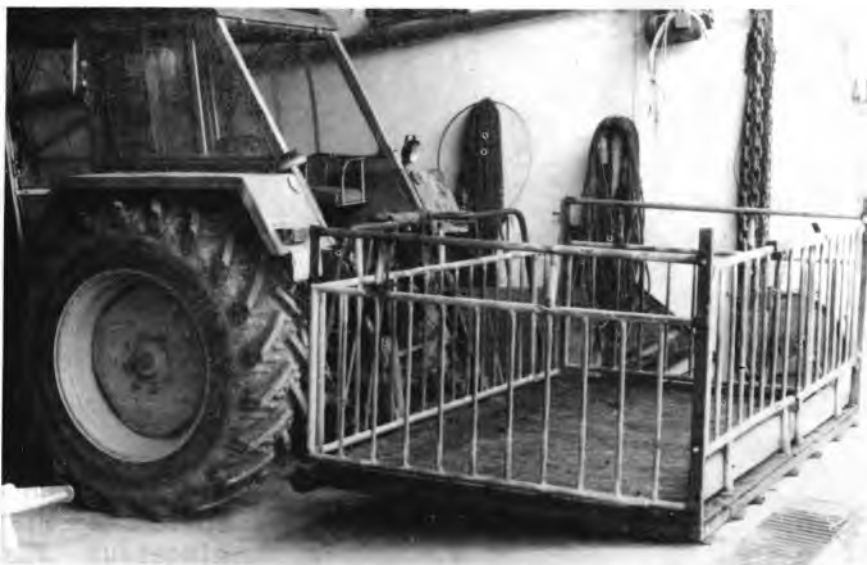
Abb. 6: Selbstgebaute Trans- portbox für acht Mast- schweine, Schlepper- anbau
