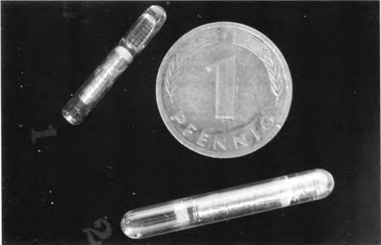
Abb. 3: Informationsträger Injektat im Größenvergleich: 1) Länge 19 mm, Durchmesser 2,8 mm 2) Länge 28 mm, Durchmesser 3,7 mm (KONERMANN, 1994)
