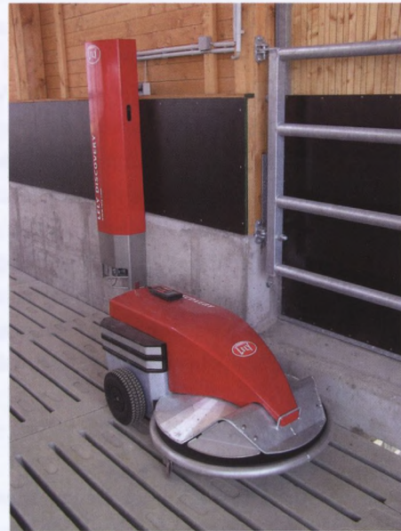
Abb. 45: Die Vollautomatisierung schreitet nicht nur beim Melken sondern auch in anderen Bereichen voran - Reinigungsroboter an der Ladestation (Foto: Hartmann)
