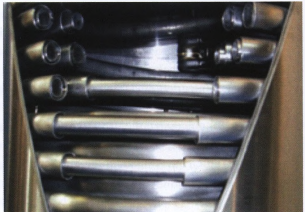
Abb. 10: Rohrkühler mit ummanteltem Innenrohr für separate Leitung von Milch und Kühlflüssigkeit im Gegenstrom (Foto: Häußermann)
