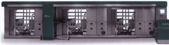
Abb. 3: Beispiel für in Reihe angeordnete Melkboxen mit parallel laufendem Ansetzautomaten (Foto: GEA)
