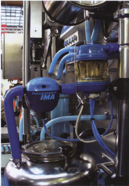
Abb. 13: Messsystem IMA-Fullwood zur Beurteilung der Euter- und Tiergesundheit am AMS (Foto: Reinecke)
