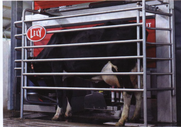
Abb. 5: Melkbox mit geradlinig verlaufendem Zu- und Ausgang (Foto: Lely)
