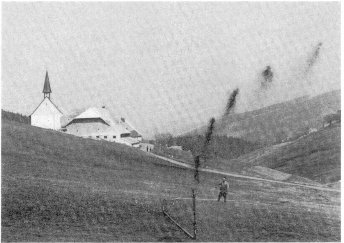
Abb. 118: Der Spezialgüllewerfer arbeitet selbständig; jedoch muß auch dieser immer wieder umgesetzt werden. Durch die kreisförmige Beregnung ist eine sehr gleichmäßige Verteilung nicht möglich
