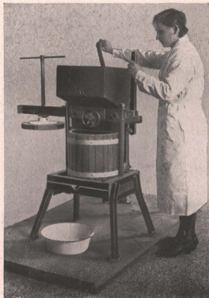
Obstmühle und Presse in einem Gerät vereint
