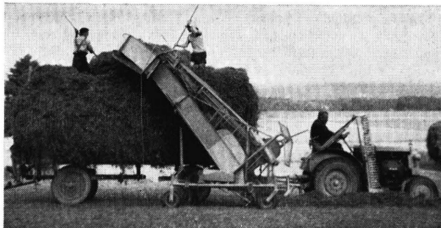
Abb. 6: Seitlich laufender Zapfwellen-Fuderlader mit vom Schleppersitz aus bedienbarer Wendehilfe. Wagen und Schlepper laufen neben dem Schwad
