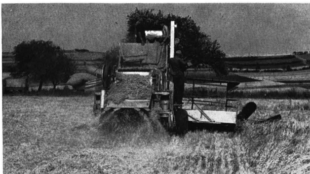
Abb. 10: Strohschneider am Mährescher empfehlen sich dort, wo auf die Strohbergung verzichtet werden kann
