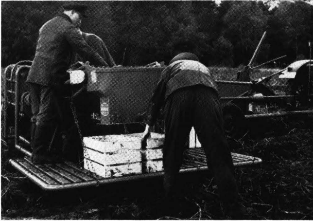
Abb. 4: Die Kiste als Zwischenbehälter an einer Sammelerntemaschine. Füllgewicht 25 kg
