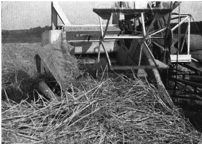
Abb. 3: Der stark lagernde Hafer staut sich auf dem Halmteiler. Ein rotierender Halmteiler wäre hier am Platze
