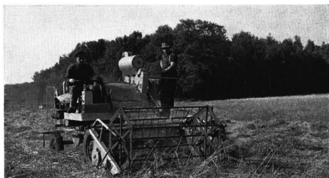
Abb. 5: Mähdrescher mit gesteuerter Haspel — auch Pick-up-Haspel genannt — im Lagergetreide
