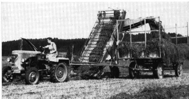
Abb. 7: Zapfwellengetriebener Fuderlader mit angebaubtem Seitenförderer, der auf die Wagenmitte lädt. Seitlich laufender Wagen, der Schlepper muß den Schwad überfahren
