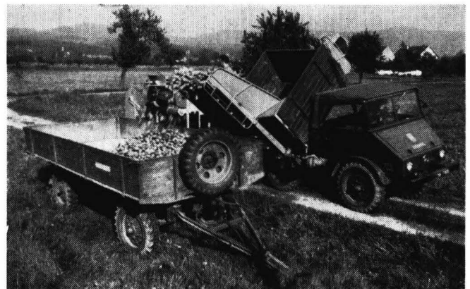
Abb. 6: Der Bunker beim Überladen auf den am Feldrand stehenden Transportwagen
