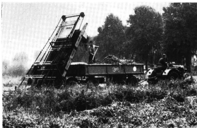
Abb. 8: Angehängter Fuderlader mit Bodenrad-Antrieb
