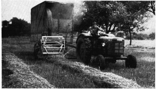
Abb. 2: Um Spritzverluste beim Schwadhäckseldrusch zu vermeiden, bespannt man die Seitenwände des Häckselwagens mit Rupfen
