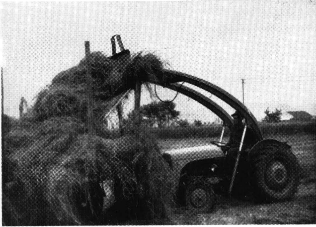
Abb. 4: Beladen des auf Abbildung 3 gezeigten Wagens mit dem Frontlader (Einmannverfahren, vorgewelktes Gras). An das Aussehen muß man sich gewöhnen. Der Wagen wird vor dem Nachhausefahren mit der Handgabel abgekämmt, damit kein Erntegut unterwegs verloren geht
