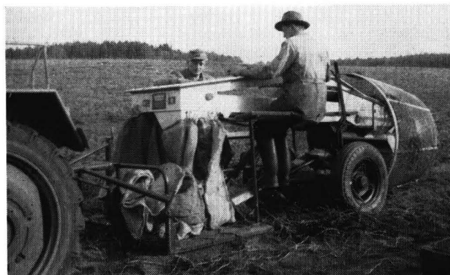
Abb. 5: Der Sack als Zwischenbehälter an einer Sammelerntemaschine
