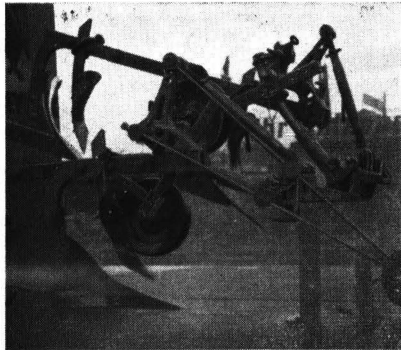
Abb. 2: Die Mechanik eines modernen Anbauwechsellpfluges. 4-Gelenks-Pflug auf Ackerschleife
