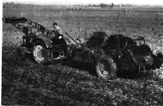
Abb. 2: Der Stallmiststreuer verteilt den Mist gleichmäßiger als es von Hand möglich ist
