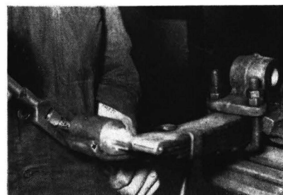
Abb. 3: Aufreiben einer Bronzebüchse von fachmännischer Hand mit zweckmäßigem Werkzeug
