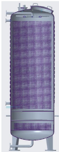
Abb. 2: Modell des Rieselbettreaktors zur Wasserstoff-Methanisierung (© Holl und Vervin)
