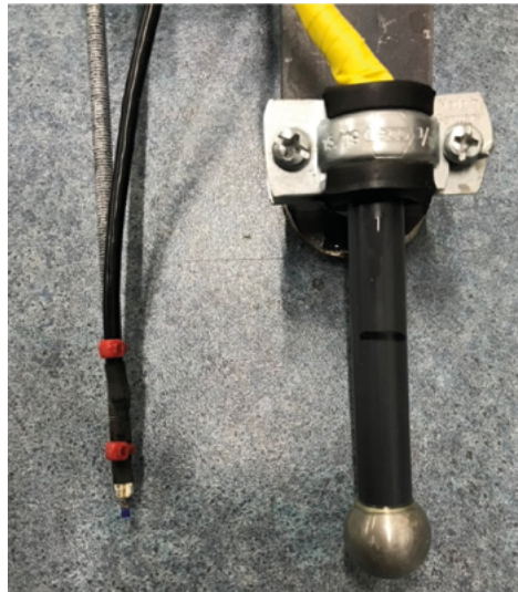
Abb. 1: Aluminiumkugel zur Bestimmung lokaler Strömungsgeschwindigkeiten – Wärmeübergangssonde (WÜS)
