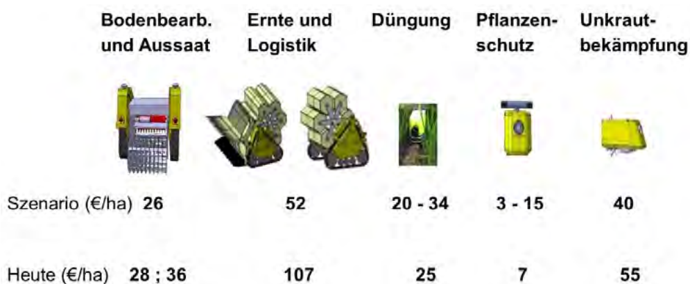
Abb. 3: Vergleich der Arbeitserledigungskosten pro Hektar zwischen autonomen Landmaschinenkonzepten und heutiger Landtechnik nach Zahlen des KTBL (Wegener et al. 2019)
