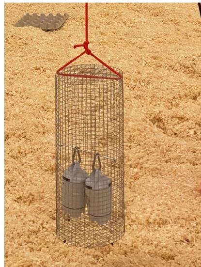
Abb. 2: Darstellung des Schutzes der Messsysteme auf Tierhöhe (© D. Werner)
