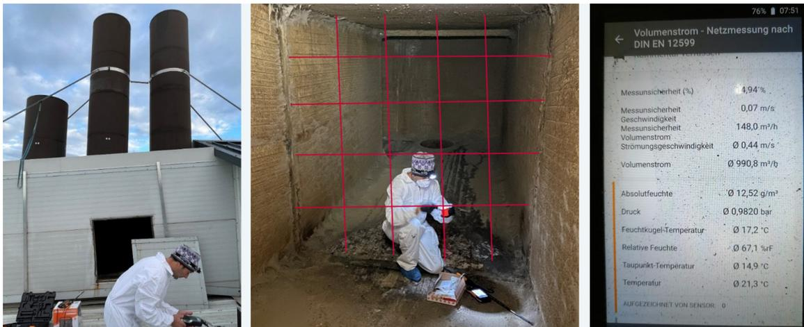
Abb. 2: Schweinebetrieb: Zugang zentrale Ablufteinheit (links), skizzierte Rastermessung in Abluftschacht (Mitte) und Display testo 400 (rechts) (Volumenstrom-Netzmessung nach DIN/ÖNORM EN 12599) (© M. Kropsch)
