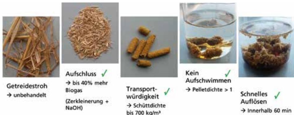
Abb. 2: Prinzip der Behandlung von Getreidestroh mithilfe der Pelletierung (© B. Schwarz)
