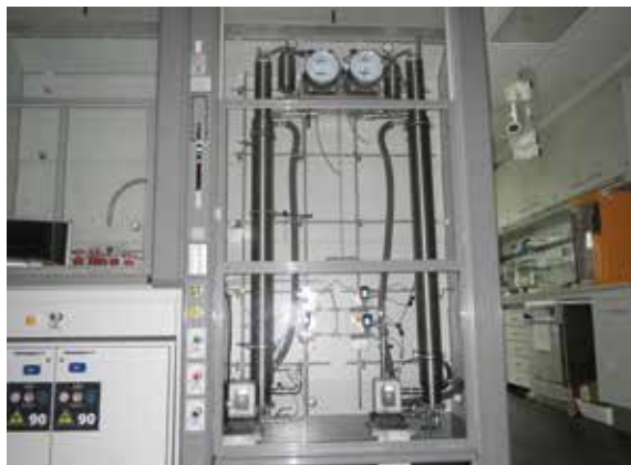
Abb. 1: Halbtechnische Methanisierungsreaktoren der FH Münster (© Matthias Gruttman)
