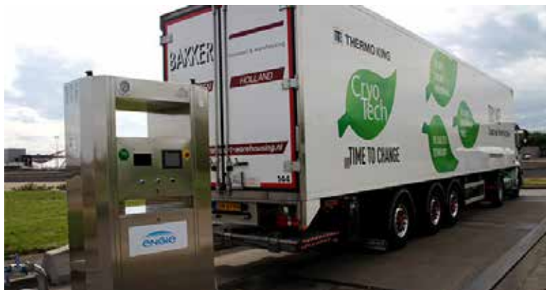
Abb. 8: Bio-LNG Tankstelle zur Betankung von LKW im Projekt Bio-GNVAL (© engie)
