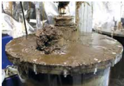
Abb. 2: Auswirkung zu hoher Schaumentwicklung (© Faika Bozankaya)
