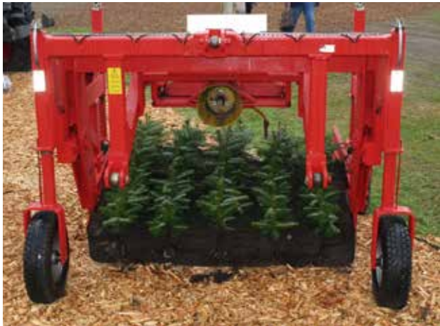
Abb. 2: Beetroder Fobro 2000 der Firma Baertschi AG (Foto: W. Graf, KTBL)
