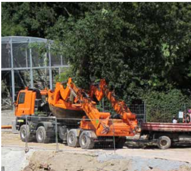
Abb. 5: Großbaumverpflanzgerät Optimal 3000 der Firma Opitz als LKW-Aufbau (Foto: W. Graf, KTBL)
