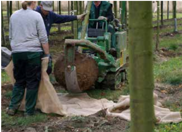
Abb. 3: Ballenschneider der Firma Holmac im Einsatz in einer Alleebaumschule (Foto: W. Graf, KTBL)
