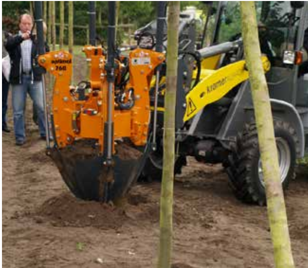
Abb. 4: Ballenstecher Optimal 760 der Firma Opitz im Frontanbau an einen Radlader (Foto: W. Graf, KTBL)
